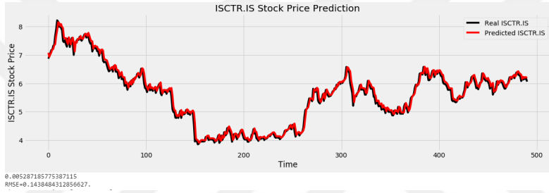
Şekil 6.27: Bütün katmanları GRU ve LSTM tipi nöronlarla oluşturulmuş derin öğrenme mimarisinin 60 çevrim sayısı ile ve geriye dönük 10 günlük zaman penceresi üzerinden eğitilmiş modelin test performansı. Kırmızı grafik tahmin, siyah grafik ise gerçek verileri göstermektedir. RMSE değeri 0,143 çıkarken, önerdiğimiz TRTP metriği 0,005287 olarak hesaplanmıştır.
