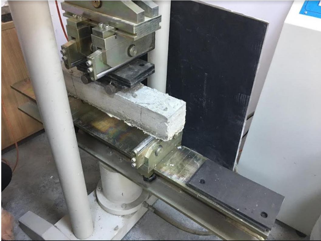
Şekil 5.4 Dört noktalı eğilme deneyi
