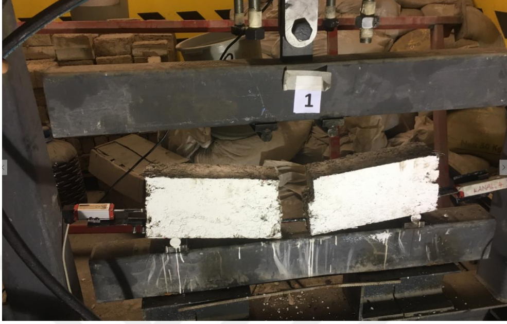
Şekil 5.6. Mafsallı kiriş aderans deneyi
