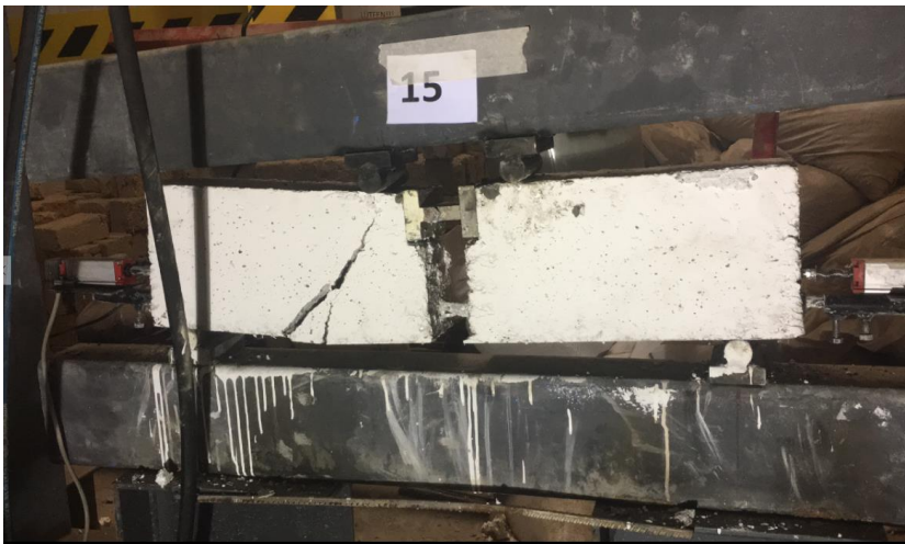
Şekil 6.1 Aderansı Tam Olan ve Kırılan Numuneler
