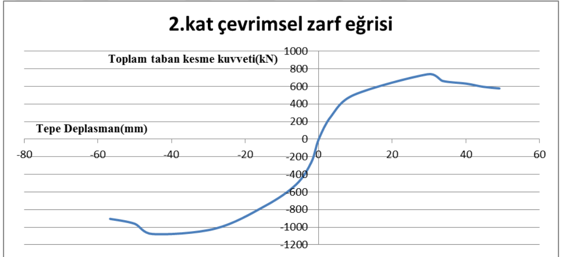
Şekil 4.8. Deney numunesi 1'e ait, maksimum taban kesme kuvveti 2. kat ötelenmesi histeresis eğrisi ve zarf eğrisi (RS)
