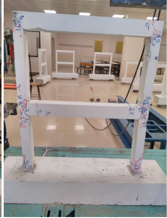
Şekil 4.6. Deney numunesi 1'de oluşan çatlakların ve hasarların, ön ve arka yüzden şematik olarak gösterimi
