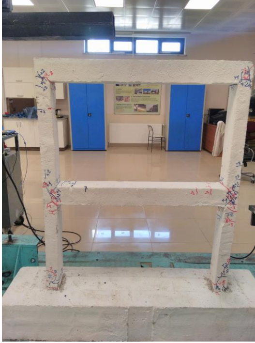
Şekil 4.6. Deney numunesi 1'de oluşan çatlakların ve hasarların, ön ve arka yüzden şematik olarak gösterimi
