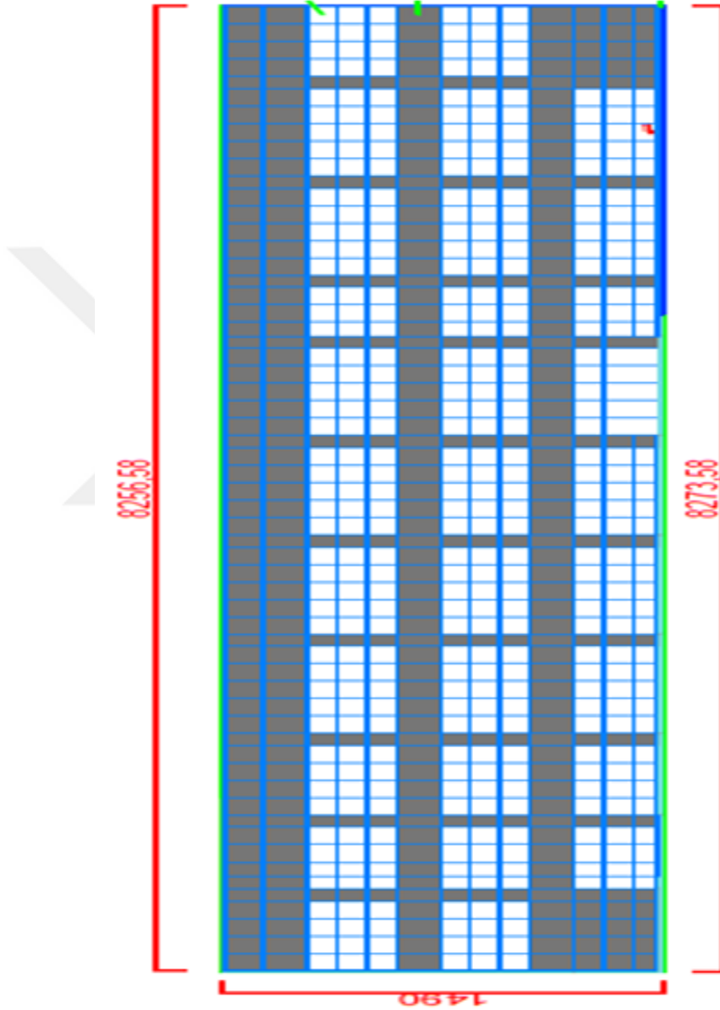
Şekil 4.2. Yapılan Çalışmada Cam Giydirme Cephe Kaplama Uygulanması
