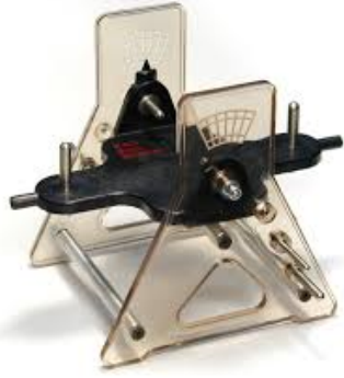
Şekil 3.5: Pal dengeleyici ve bant uygulaması
