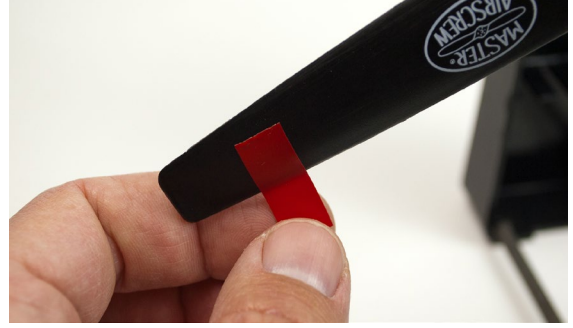
Şekil 3.5: Pal dengeleyici ve bant uygulaması
