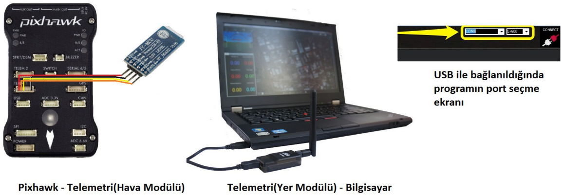
Şekil 3.19: Telemetrinin yer ve hava modüllerinin bağlanması ile port seçim ekranı
