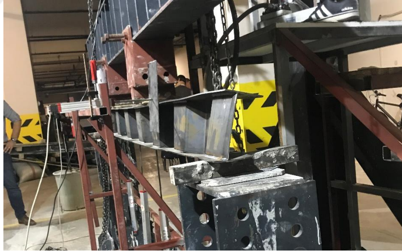
Şekil 4.8. SBT-3 kirişin başlık burulması.
