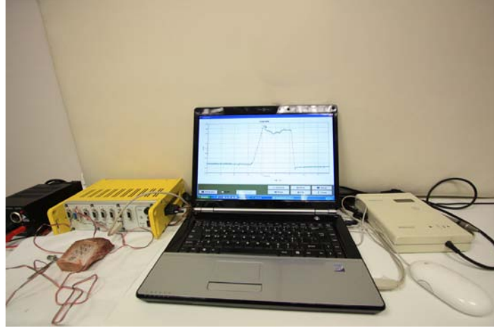
Şekil 3.5. İmplantların primer stabilitesinin ölçülmesi için kullanılan ekipman. Soldan sağa manuel tork aletine bağlı veri aktarım sistemi, verilerin yazılımda görüntülediği bilgisayar ve Periotest cihazı görülmektedir.
