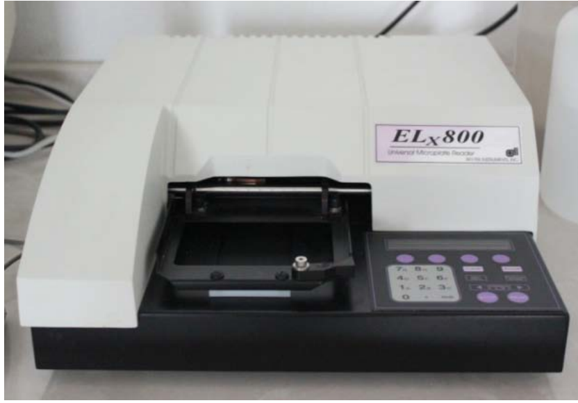
Şekil 3. 12. Plak rengini okumak için kullanılan ELx 800 Universal Microplate Reader
