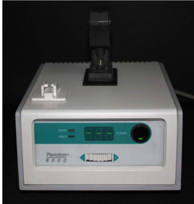
Şekil 3. 6. Toplanan DOS örneklerinin miktarının ölçülmesinde kullanılan Periotron 8000® cihazı
