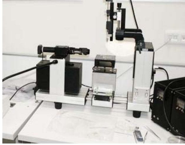
Şekil 10: Temas açısı ölçüm cihazı ( OCA 20 contact angle system, Dataphysics, Germany)
