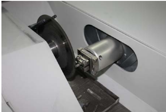
Şekil 4: Kesme cihazı ( Accutom-50, Struers Ltd, Lanarkshire, İngiltere )
