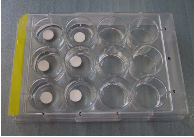
Şekil 3.5 Disklerin antimikrobiyal solüsyon içinde bekletilmesi
