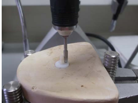
Şekil 3.7. Paralelometre ile seramik yüzeyindeki düzensizliklerin giderilmesi
