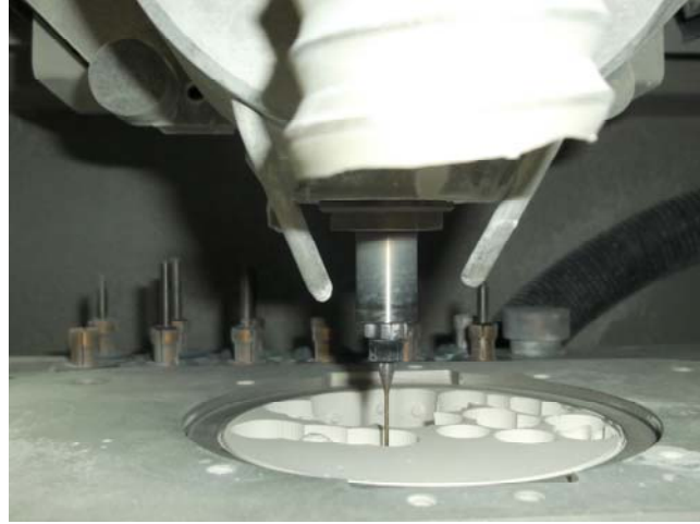
Şekil.3.2. YenaDent D40 CAM ünitesinde örneklerin üretilmesi
