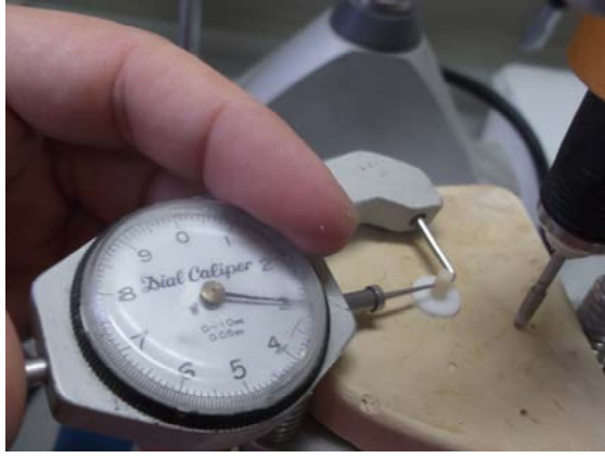
Şekil 3.8. Kumpas ile örnek çaplarının kontrol edilmesi
