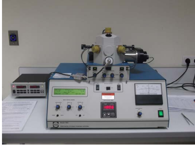
Şekil 3.13. Örneklerin Au-Pd ile kaplanması
