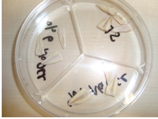
Şekil 3.11 Critical point dryer sonrası dehidrate örneklerin elde edilmesi
