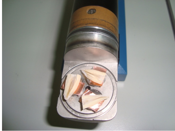
Şekil 3.12 Örneklerin altın-palladyum ile kaplanması
