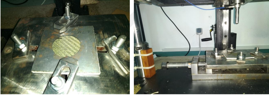
Şekil 3.29 Test numune plakalarının tutuculara bağlantısı
