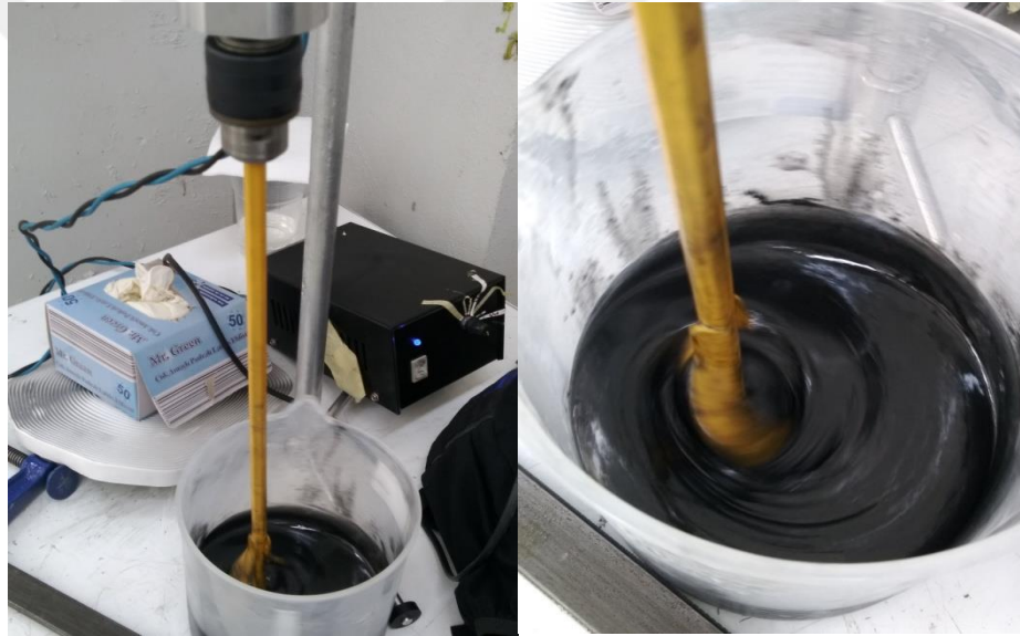
Şekil 3.24 Nano-toz karışımlarının hazırlanması
