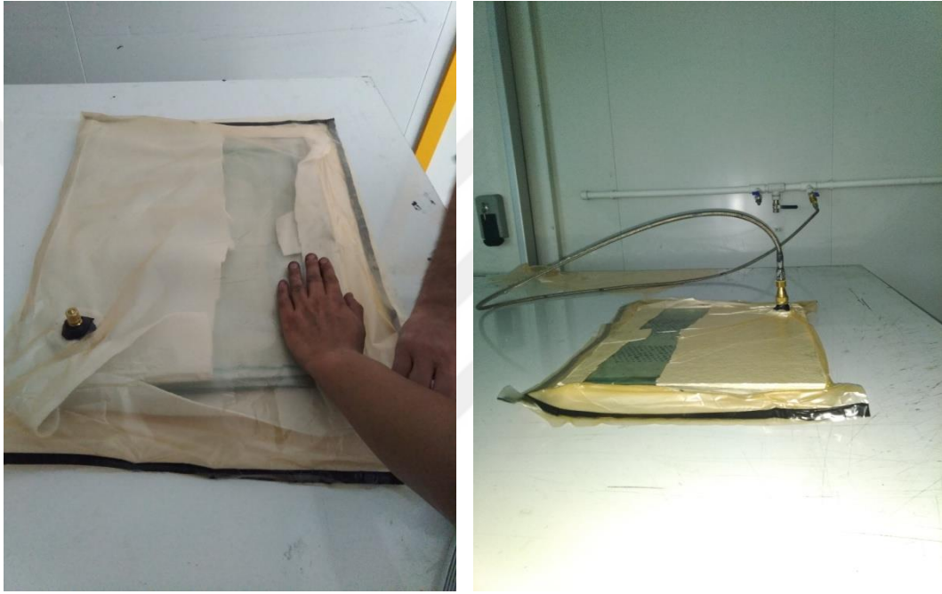
Şekil 3.25 Vakumlama işlemi öncesi (sol) ve vakumlama işlemi sonrası (sağ)
