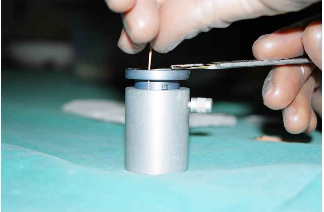
Şekil 3.7 İmplant edilen tüm materyaller 10 mm boyunda kesilerek standardize edildi. Şekilde .04 Taper Resilon materyalinin hazırlanması görülmektedir.
