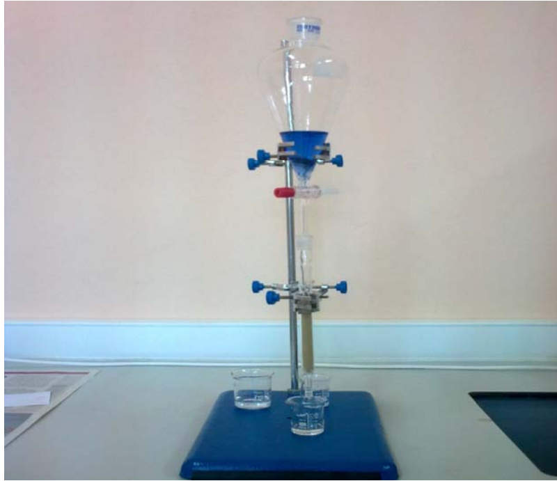
Ek Şekil 4. Kolon Adsorpsiyon Çalışması sonrası Rengi Açılan Remazol Brilliant Blue R Boyası
