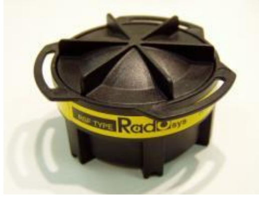
Şekil 2.3: CR-39 detektörünün içinde bulunduğu radosys ışınlama kutusu.
