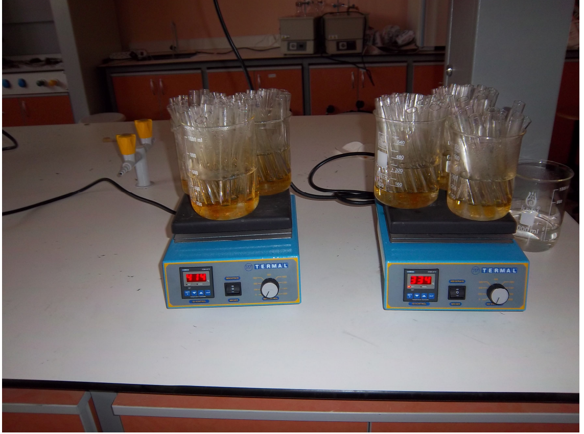
Resim 3.9 Deneyde kullanılan Tilapia balıklarının ( Oreochromis niloticus ) doku ve organlarının nitrik asit ve perklorik asitle yakılması
