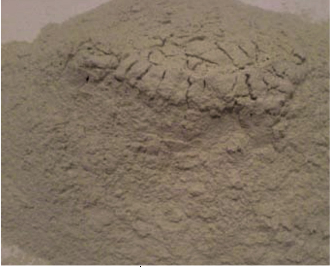
Resim 3.1 Deneyde kullanılan ve İstanbul Rota madencilik A.Ş.'den alınan <75 mikron çapındaki zeolitin toz halindeki genel görüntüsü
