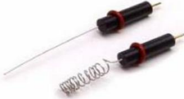
Resim 2.6. Platin karşit elektrotlar
