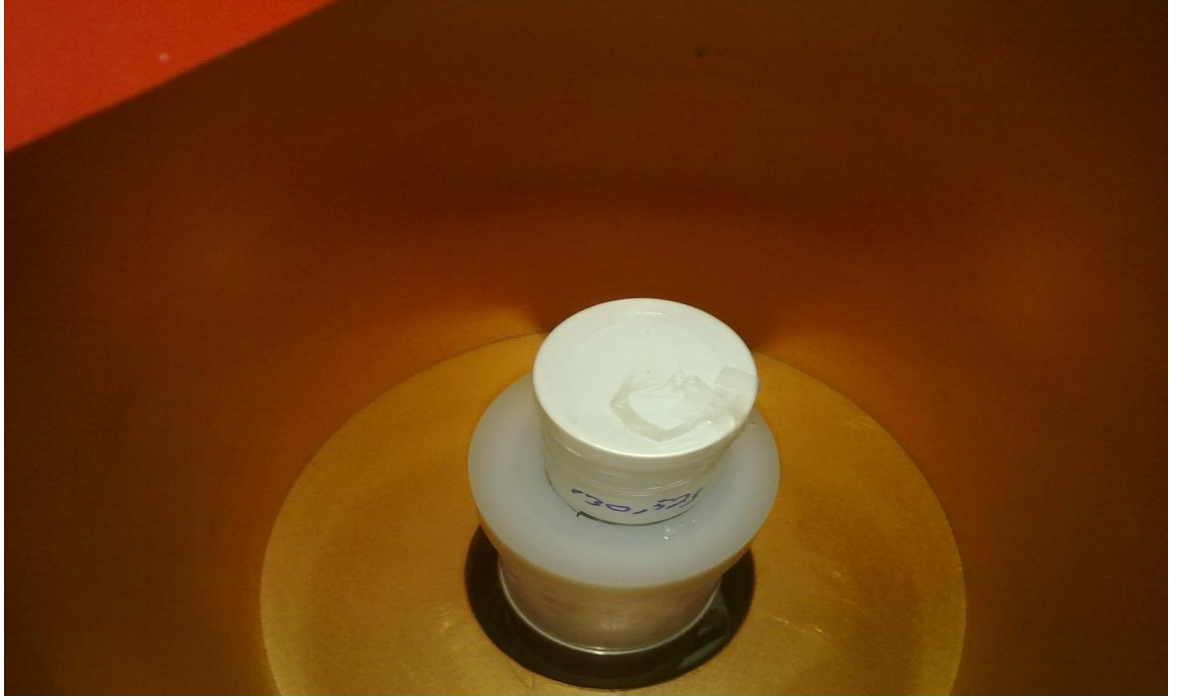
Şekil 2.8. Ölçüm işlemi için detektöre yerleştirilmiş toprak örneği
