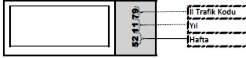
Şekil 2.2.Lam üzerinde haftalık kodlama sistemi
