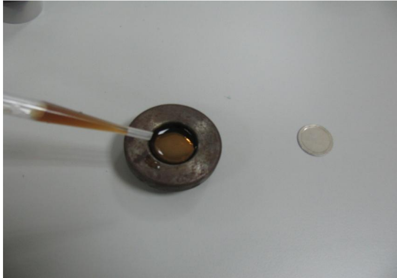
Resim 3.5. Kupanın hazneye yerleştirilmesi ve ferrosıvı çözeltisinin hazneye boşaltılması
