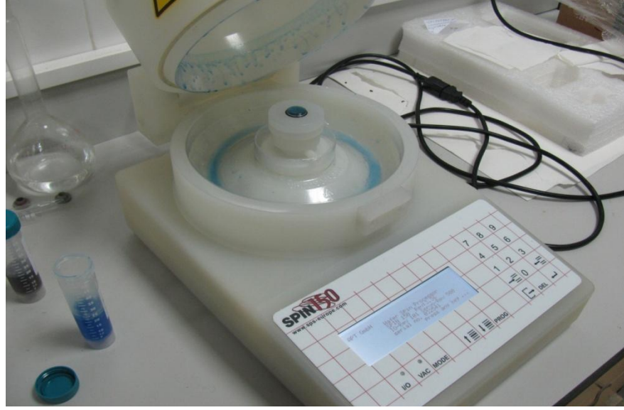
Resim 3.7. Nanoparçacık kaplı hard disk kupalara polimer kaplama ünitesi
