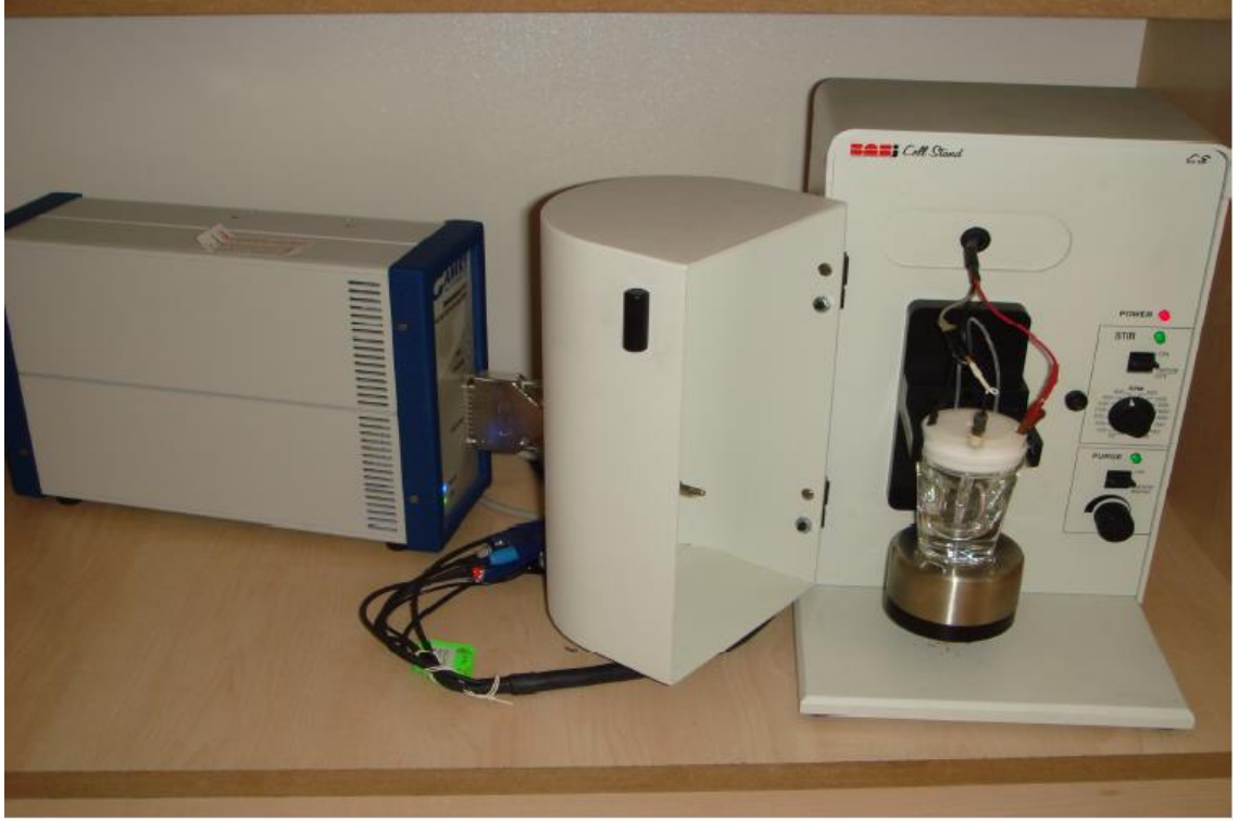
Şekil 3.2. Elektrokimyasal ince film büyütme sistemi (Gamry Reference 600 Potentiostat/Galvanostat)
