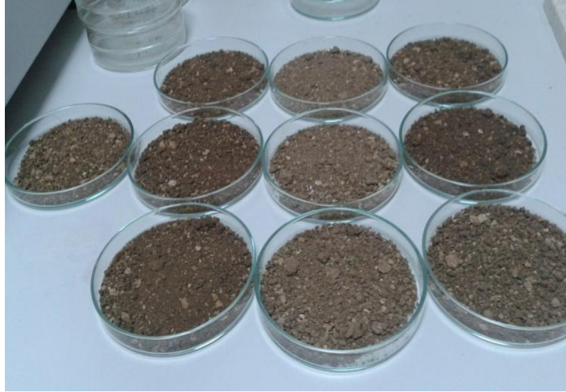
Şekil 2.1. Fırına konulmak(105°C de 24 saat) üzere tartılmış 25g toprak. örn.
