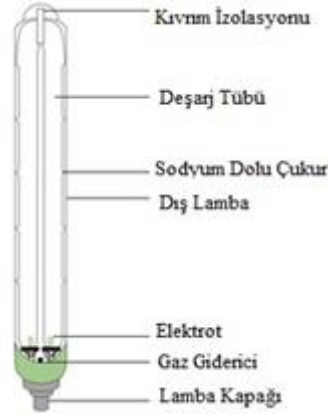
Resim 1.3 Düşük basınçlı sodyum lamba yapısı [3]
