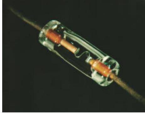
Resim 1.1 1960'larda N. Holonyak Jr tarafından üretilen ilk görünür kırmızı LED [17]
