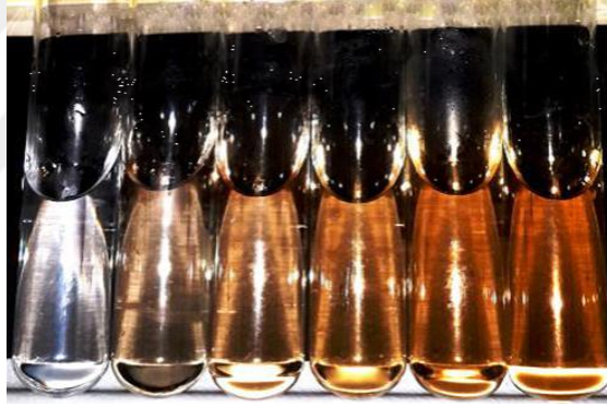
Şekil 2.3. Ninhidrin ayıracağı ile standart örneklerde gözlenen renk değişimi
