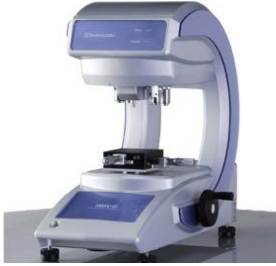
Şekil 2.3. Kompozitlerin sertlik ölçümlerinin yapıldığı mikrosertlik cihazı
