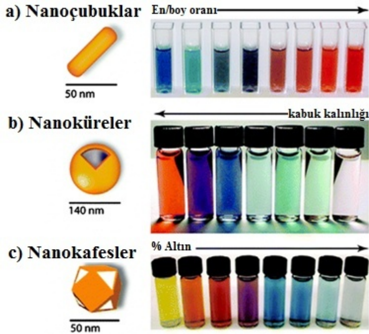
Şekil 1.8. Farklı boyut ve şekillerde sentezlenen altın nanopartiküller içeren çözeltiler
