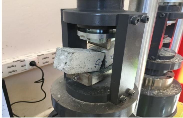
Resim 3.9. Çimento harç numunelerinin eğilme dayanımı deneyi
