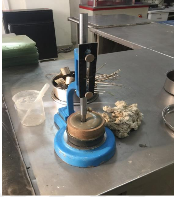
Resim 3.1. Vicat Aleti ile imento standart kıvam tayini deneyinin yapılması
