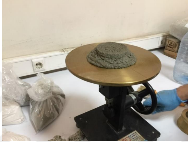
Resim 3.3. Taze harç kıvamının belirlenmesinde kullanılan yayılma tablası
