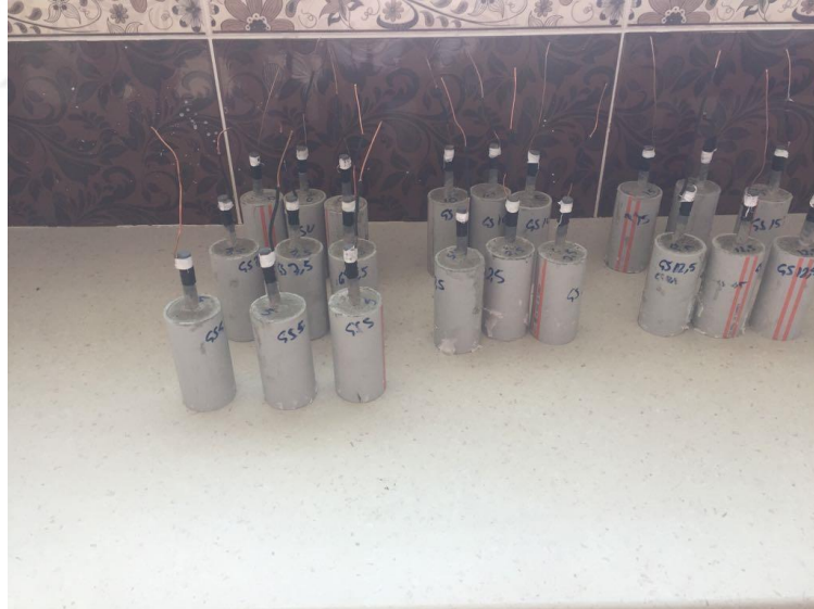
Resim 3.11. Üretilen korozyon numuneleri
