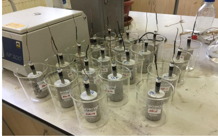
Resim 3.14. Cam beher içerisinde korozif ortam oluşturulan donatılı harç numuneleri
