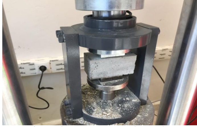
Resim 3.10. Çimento harç numunelerinin basınç dayanımı deneyi
