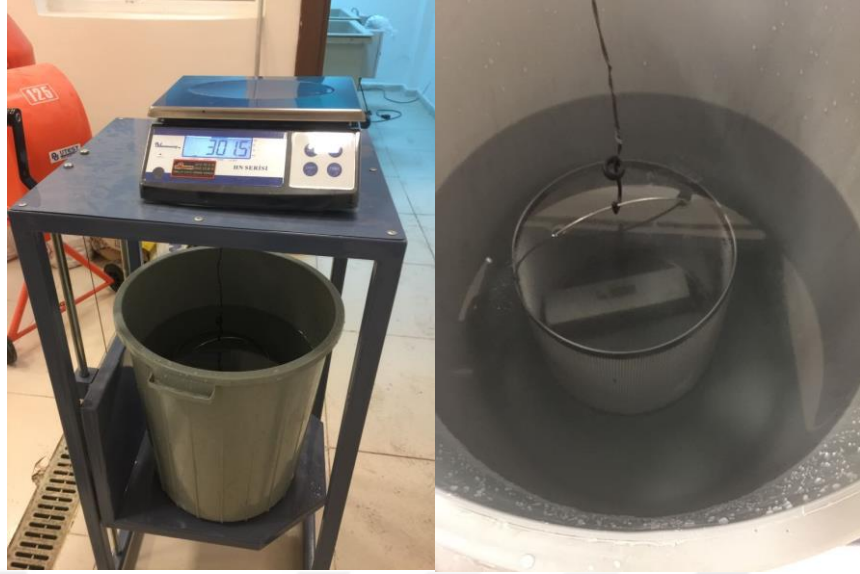
Resim 3.4. Arşimet terazisi ve su içinde asılı kefesini
