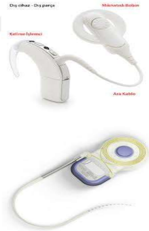
Şekil 1: Koklear implant dış ve iç parçaları
