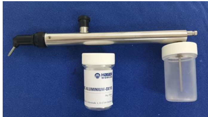
Şekil 3.8. Çalışmada kullanılan ağız içi kumlama cihazı ve Al 2 O 3 kumu
