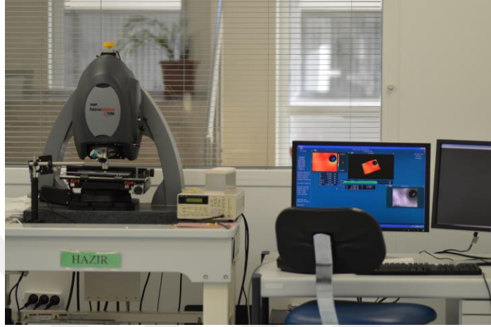
Şekil 3.17. Deneyde kullanılan optik profilometre cihazı
