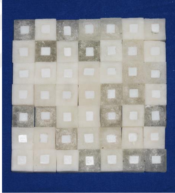
Şekil 3.2. 6 mm x 7 mm x 2 mm şeklinde kesilen zirkon örneklerin deney aşamaları için akril bloklara gömülmüş hali
