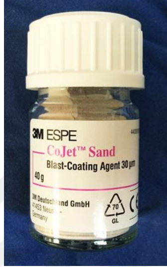
Şekil 3.9. Çalışmada kullanılan SiO 2 (Cojet) kumu
