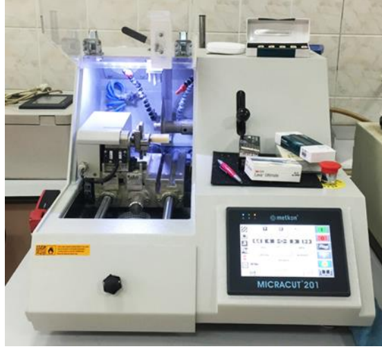
Şekil 3.1. Örneklerin hazırlanmasında kullanılan Micracut 201 cihazı
