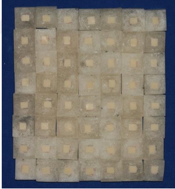
Şekil 3.4. 6 mm x 7 mm x 2 mm şeklinde kesilen hibrit porselen örneklerin deney aşamaları için akril bloklara gömülmüş hali
