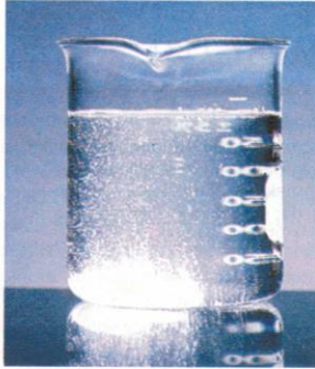
ŞEKİL 14.17 Hidrojen karbonat içeren antiasit tabletlerin asitle çözünmesi ile oluşan köpürme, çeşitli dengeleri içine alan bir seri reaksiyon zincirinin bir sonucudur.
