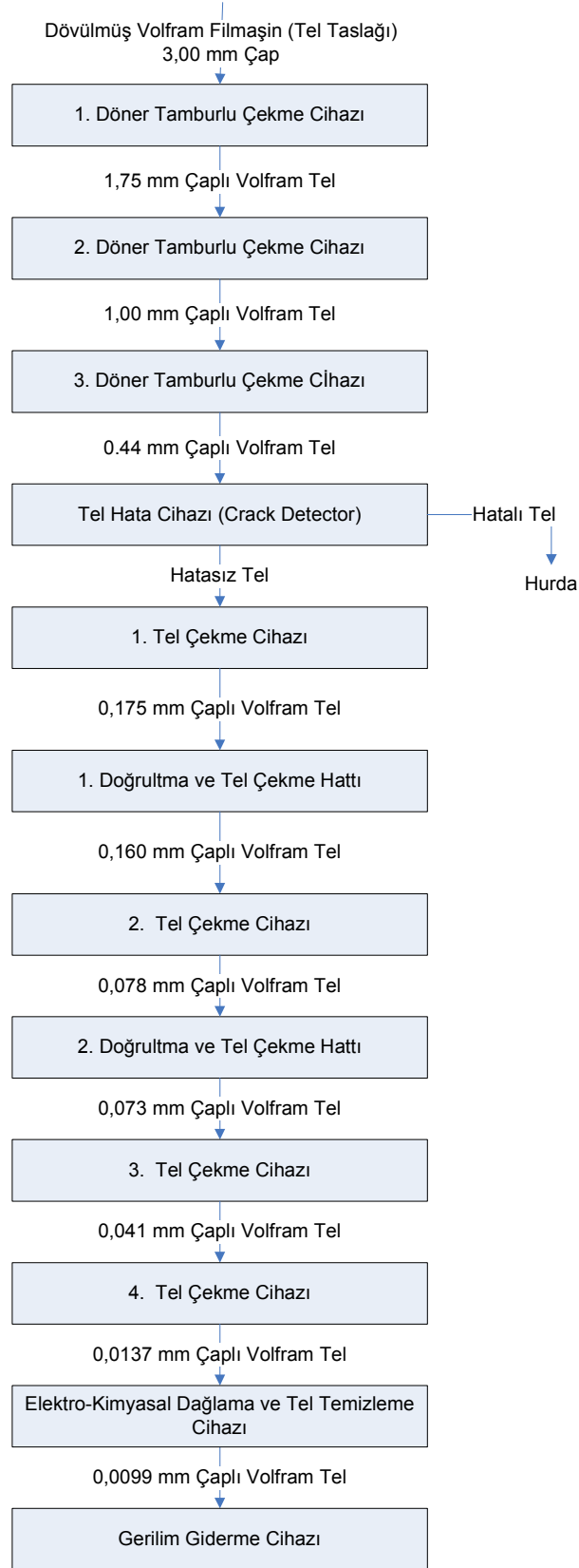
Şekil 4.10: Filmaşından tel ve ince tel çekme sistemi akış şeması
