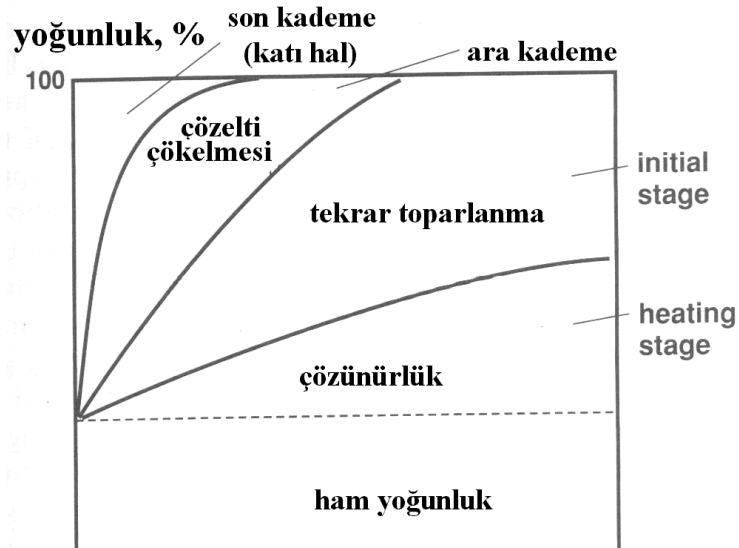
Şekil 2.18: Sıvı faz sinterlemesinde yoğunluk ile sıvı faz miktarı arasındaki değişim. Sıvı oluşumu ile beraber, katı partiküller üzerinde meydana gelen kapiler kuvvetlerin etkisiyle yoğunlaşma miktarında ani bir artış olur. Katı sıvı içinde çözüldükçe tanelerde çekme meydana gelir ve hızlı bir biçimde, sıvının porları doldurmasına izin
