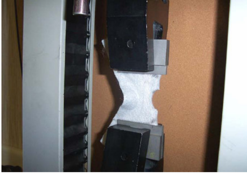
Şekil 2.9: İkizkenar Yamuk Yırtılma Deneyi
