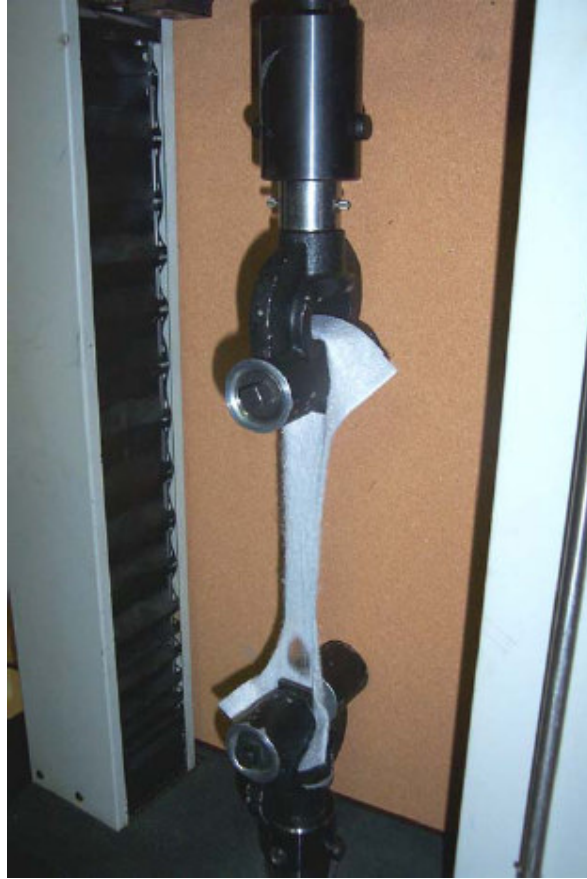
Şekil 2.10: Düz Yırtılma Deneyi
