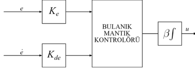
Şekil 3.3: Bulanık PI tipi kontrolöre ait blok gösterimi
