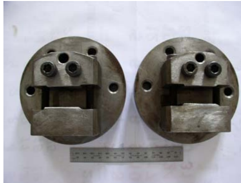
Şekil 4.12 : Deneylerde Kullanılan Tutucu Çeneler
