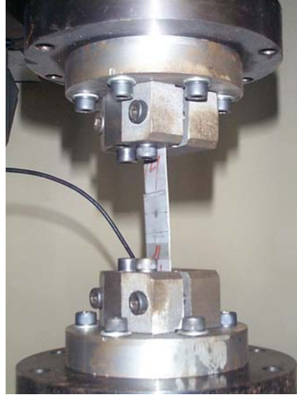
Şekil 4.14 : Çeneler Arasına Tutturulmuş Kaynaklı Yorulma Deney Numunesi
