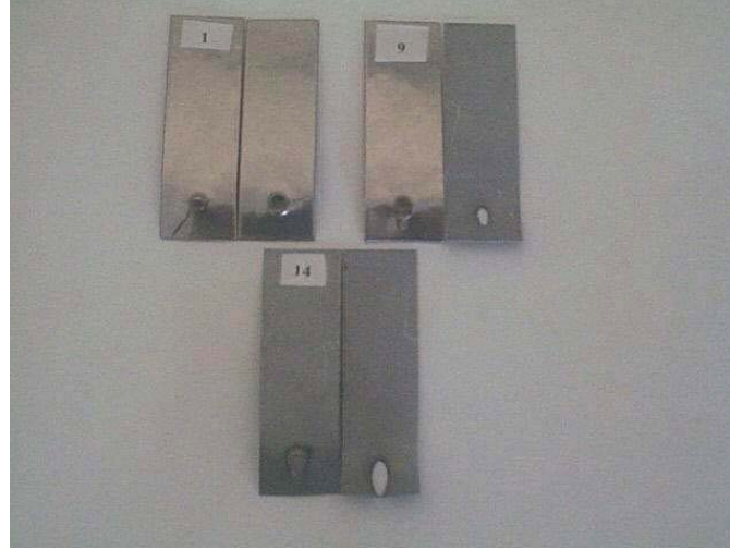
Şekil 4.7 : Çekme Deneyi Sonrası Kopan Kaynaklı Numuneler
