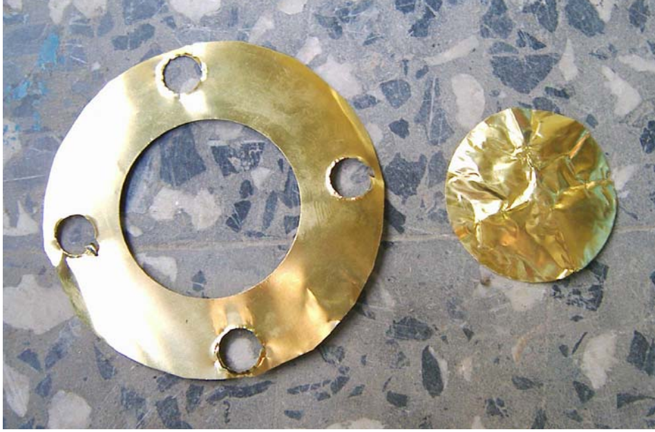
Şekil 4.5: Membranın patlama sonrası görüntüsü
