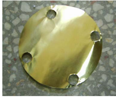
Şekil 4.4: Membranın folyo tabaka ve basınç tüpüne göre kesilmiş görüntüsü
