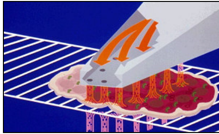
Şekil 2.10 : Sıcak hava jetlerinin ürüne teması
