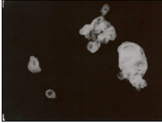
Şekil B. 24: PbSO 4 bileşiğinden üretilen bileşiğin bozunmuş yapısının TEM görüntüsü.
