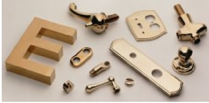
Şekil 2.21: Dekoratif amaçlı TiN kaplanmış çeşitli aksesuarlar [46].
