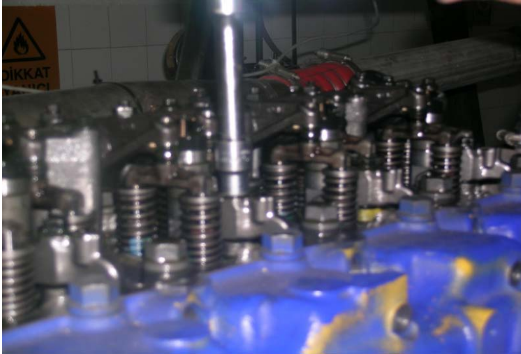
Şekil 4.16 : Enjektör Tepe Somununun Demonte Edilmesi
