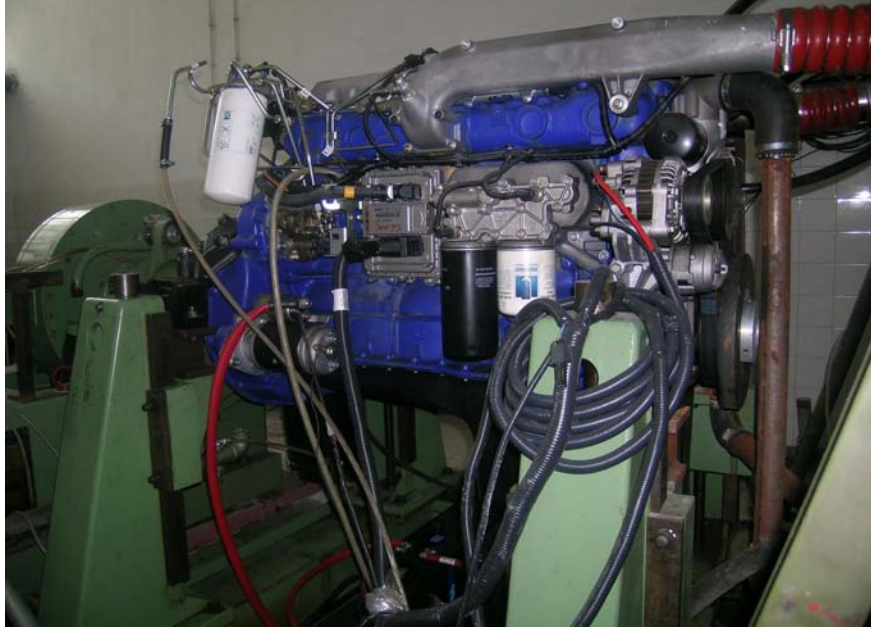
Şekil 4.5 : Test Motoru Ecotorq 300 PS
