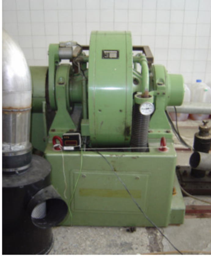
Şekil 4.9 : Schenk Marka ve Tip Elektromanyetik Fren
