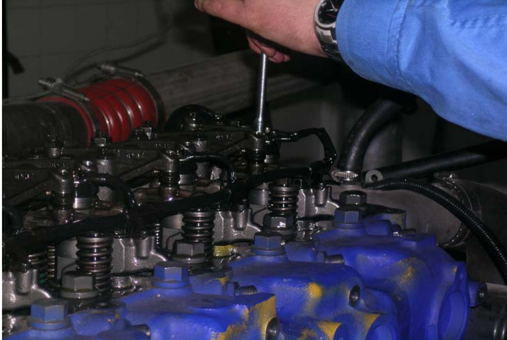
Şekil 4.18 : Elektrik Bağlantısının Enjektör Üzerinden Demonte Edilmesi
