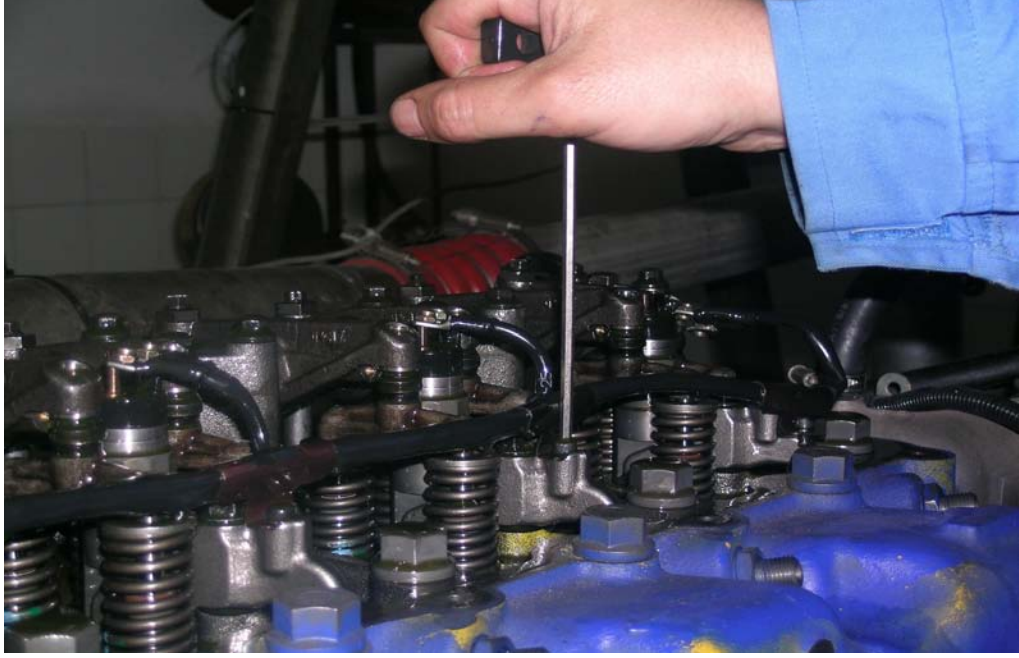
Şekil 4.15 : Enjektör Kilit Mekanizmalarının Sökülmesi
