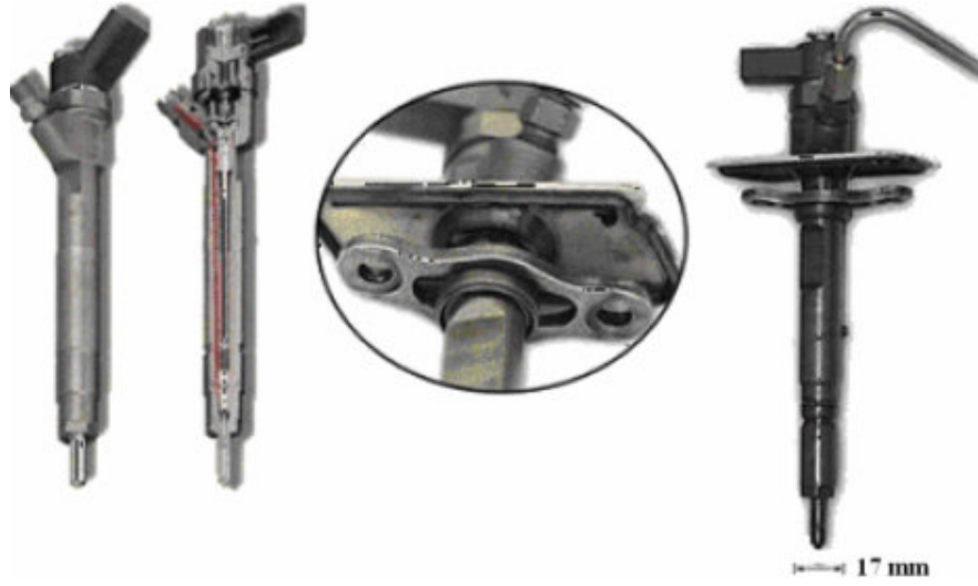
Şekil 3.16 : Selonoid Valf Kumandalı Enjektör [53]
