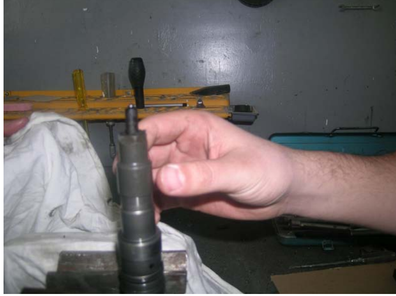
Şekil 4.21 : Gövde Muhafazasının Yerinden Çıkarılması
