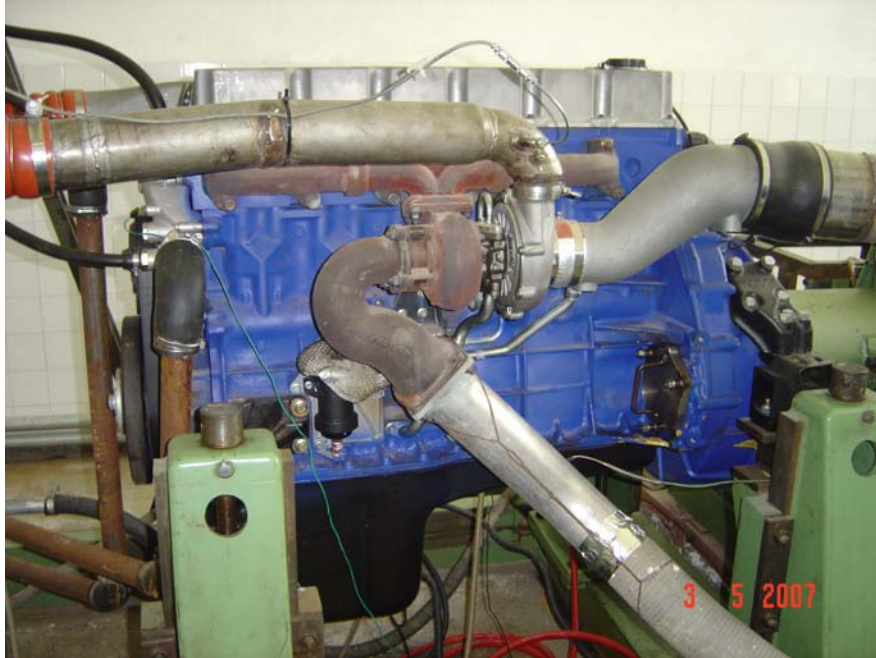
Şekil 4.6 : Test Motorunun Turbo Ünitesi
