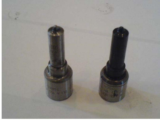
Şekil 4.23 : Dizel Yakıtı Bulanmış Enjektör Memesi
