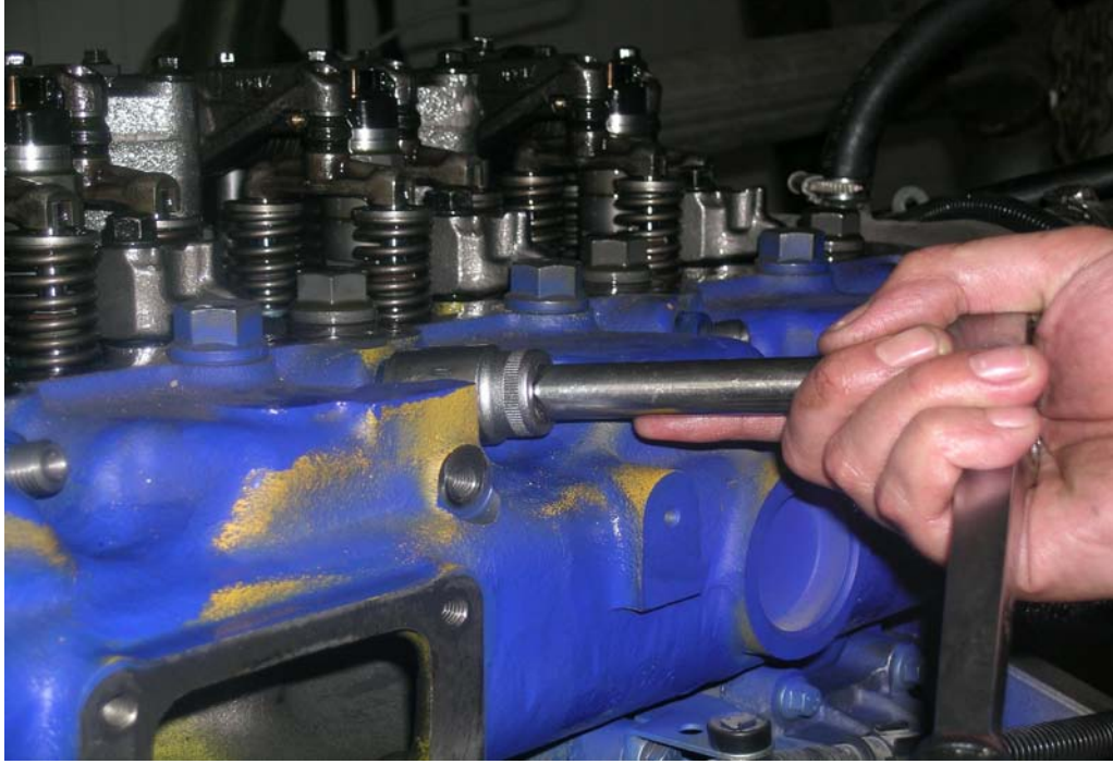
Şekil 4.17 : Filtre Elemanın Yuvasından Alınması
