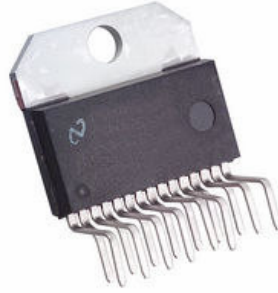
Şekil 5.16: LMD18200T H-köprüsü motor sürücüsü.
