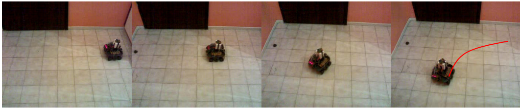
Şekil 5.23: 1. metrede algılayıcı arızası oluşma durumundaki robotun yörüngesi.
