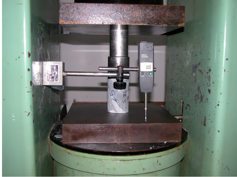
Şekil 4.26: Tek Eksenli Basınç Deneyi Düzenegi
