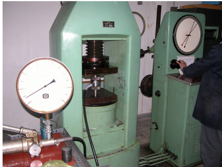
Şekil 4.27: Üç Eksenli Basınç Deneyi Düzeneği
