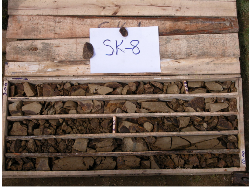
Şekil 4.10: Kağıthane Portali SK-8 3.00-10.00 m Karotları
