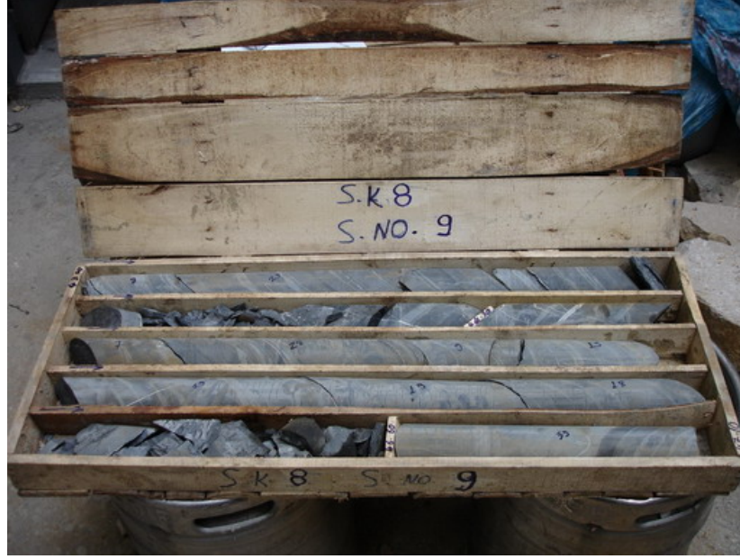
Şekil 4.12: Kağıthane Portalı SK-8 43.00-47.10 m Karotları
