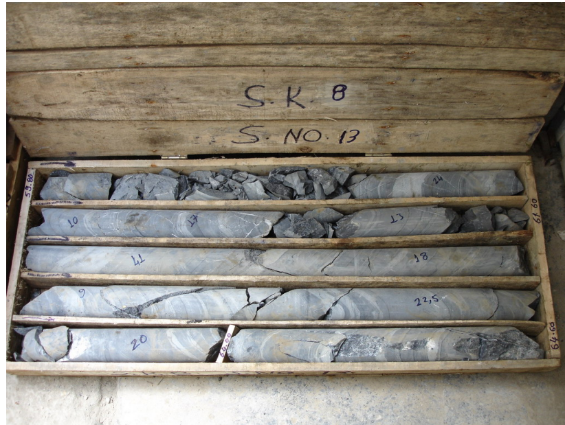
Şekil 4.13: Kağıthane Portalı SK-8 59.80-64.60 m Karotları
