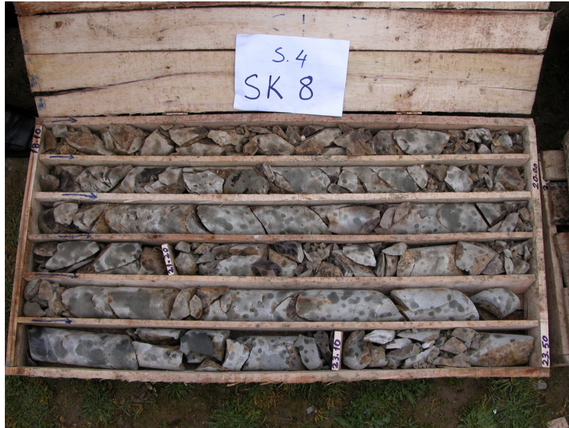
Şekil 4.11: Kağıthane Portali SK-8 18.10-23.50 m Karotları
