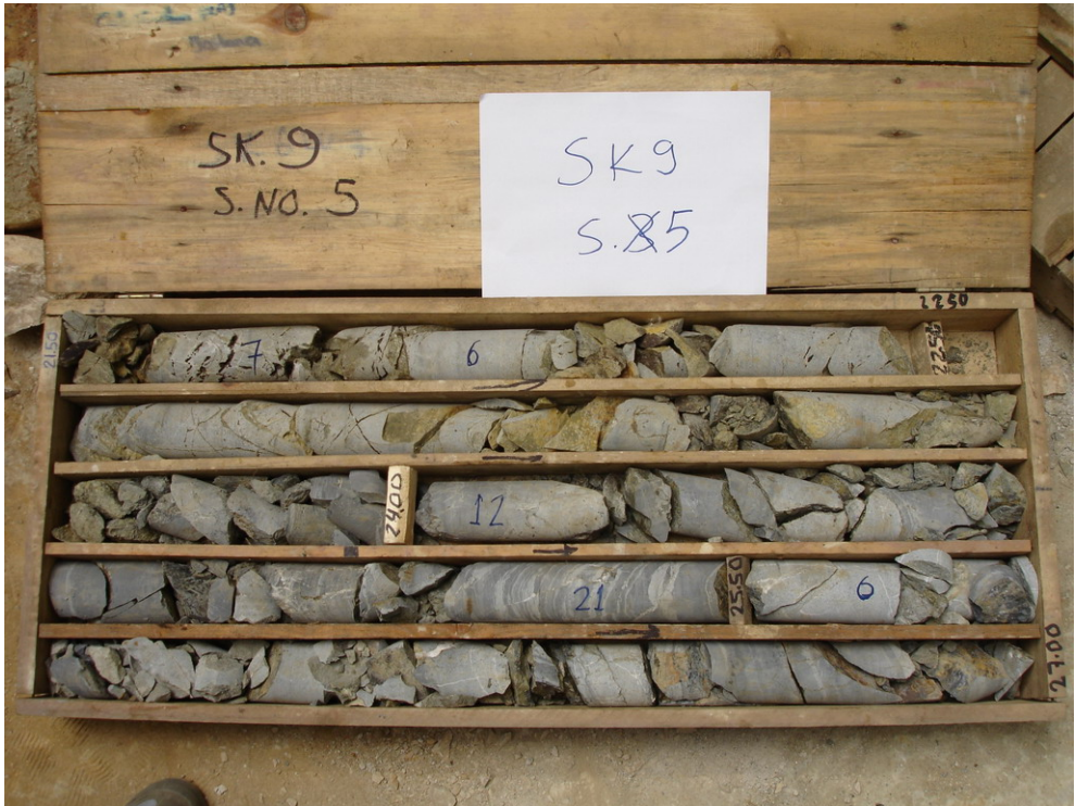
Şekil 4.16: Kağıthane Portali SK-9 21.50-27.00 m Karotları
