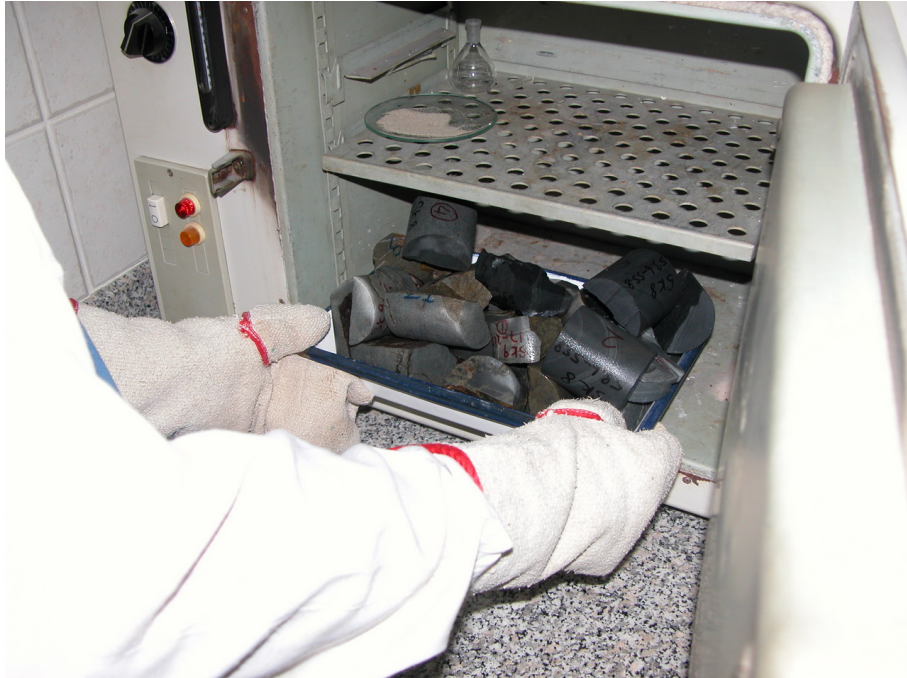
Şekil 4.18: Laboratuvar Deney Numunelerinin Etüve Yerleştirilmesi
