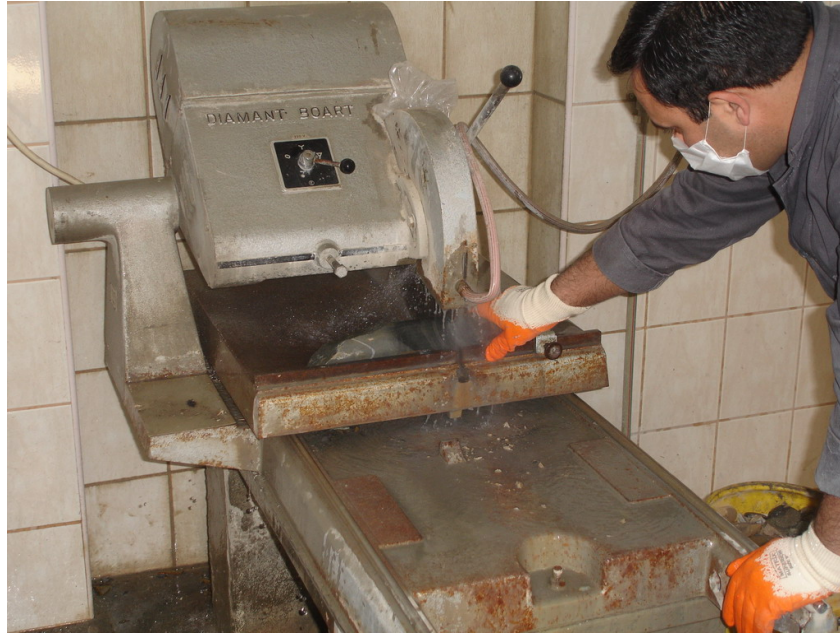
Şekil 4.21: Laboratuvar DeneYlerinde Kullanılacak Numunelerin Uygun Uzunluklarda Kesilmesi
