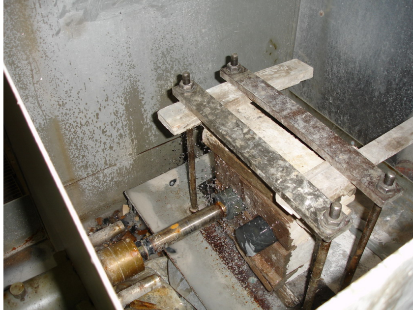
Şekil 4.22: Laboratuvarda Karot İçinden Karot Alma İşlemi (başlangıç)
