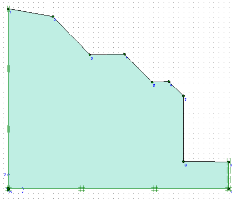
Şekil 5.14: B-B' Kesiti Desteksiz Durum Plaxis Modeli
