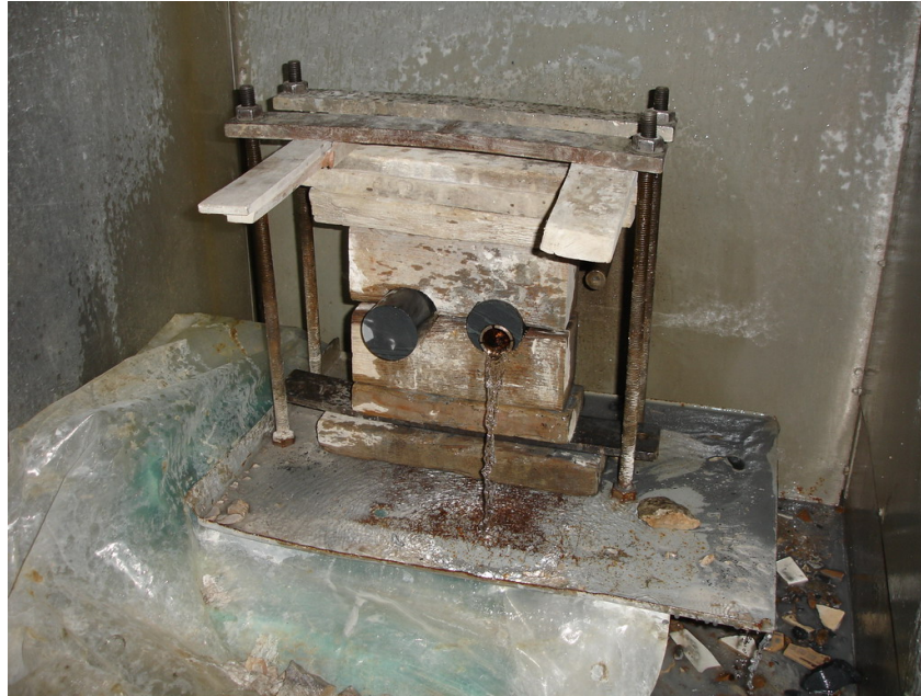
Şekil 4.23: Laboratuvarda Karot İçinden Karot Alma İşlemi (bitiş)
