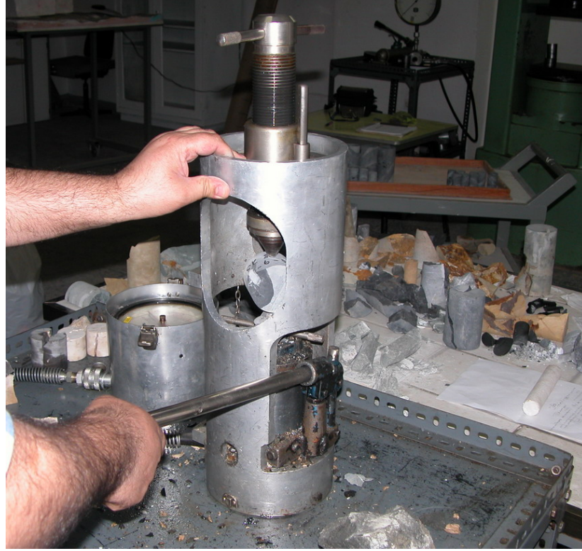
Şekil 4.28: Nokta Yükleme Deneyi Düzenneği
