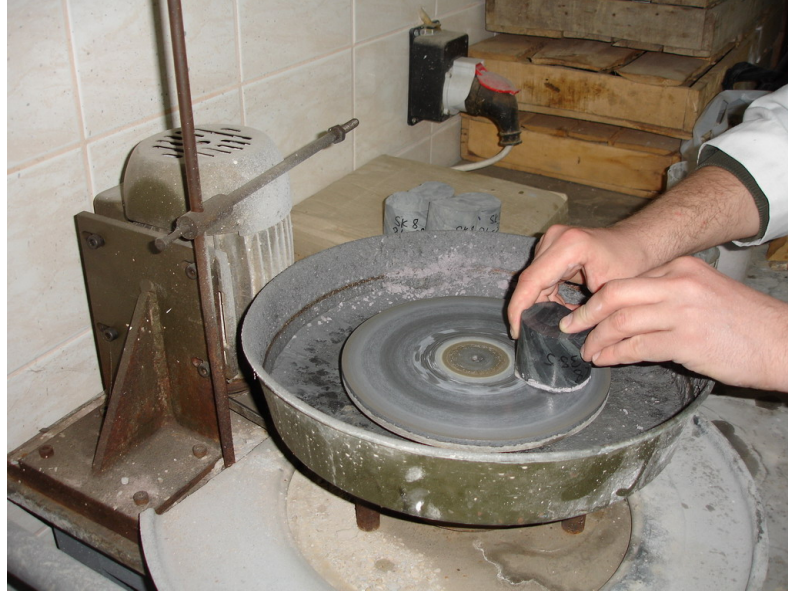
Şekil 4.24: Deney Numunelerinin Baş Kısımlarının Pürüzlerinin Giderilmesi
