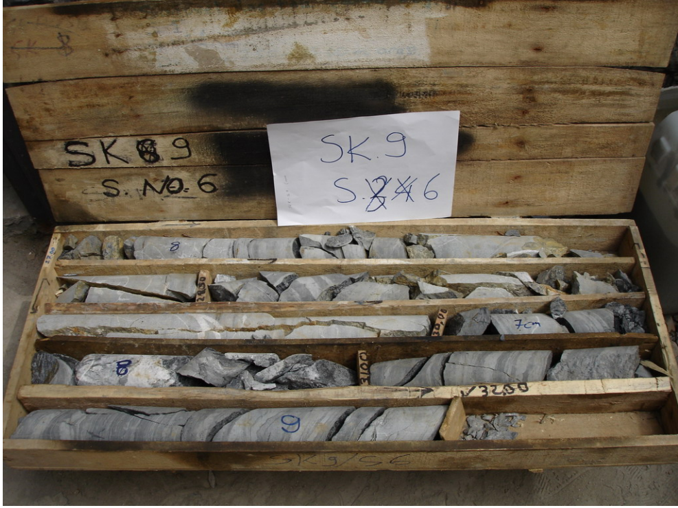
Şekil 4.17: Kağıthane Portali SK-9 27.00-32.00 m Karotları
