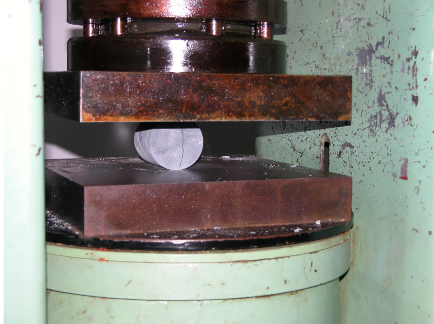
Şekil 4.29: Endirek Çekme Deneyi Düzeneği
