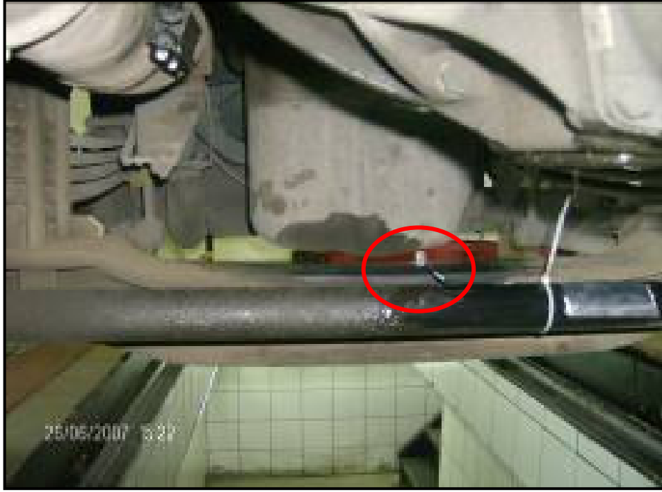
Şekil 4.9: Aks Üzerine Yerleştirilen İvme Ölçer
