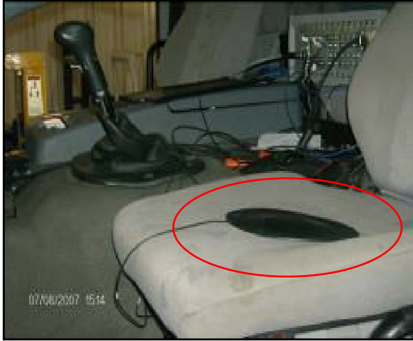
Şekil 4.6: Sürücü Koltuğuna Yerleştirilen İvme Ölçer
