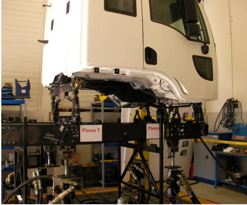
Şekil 5.10: Kamyon Kabin Rig Testi Test Düzeneđi
