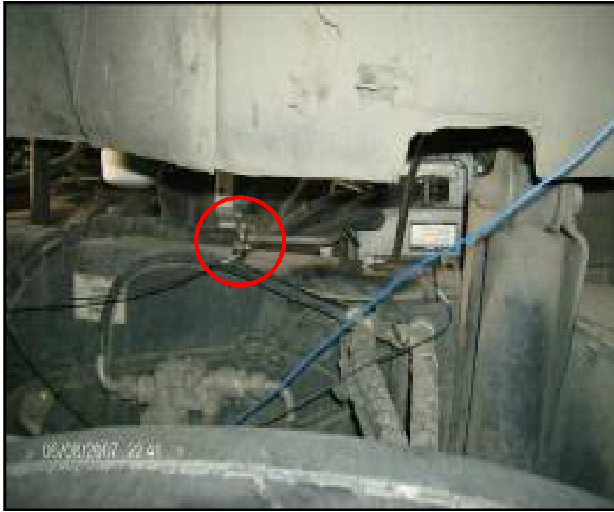
Şekil 4.8: Şasi Kolu Üzerine Yerleştirilen İvme Ölçer
