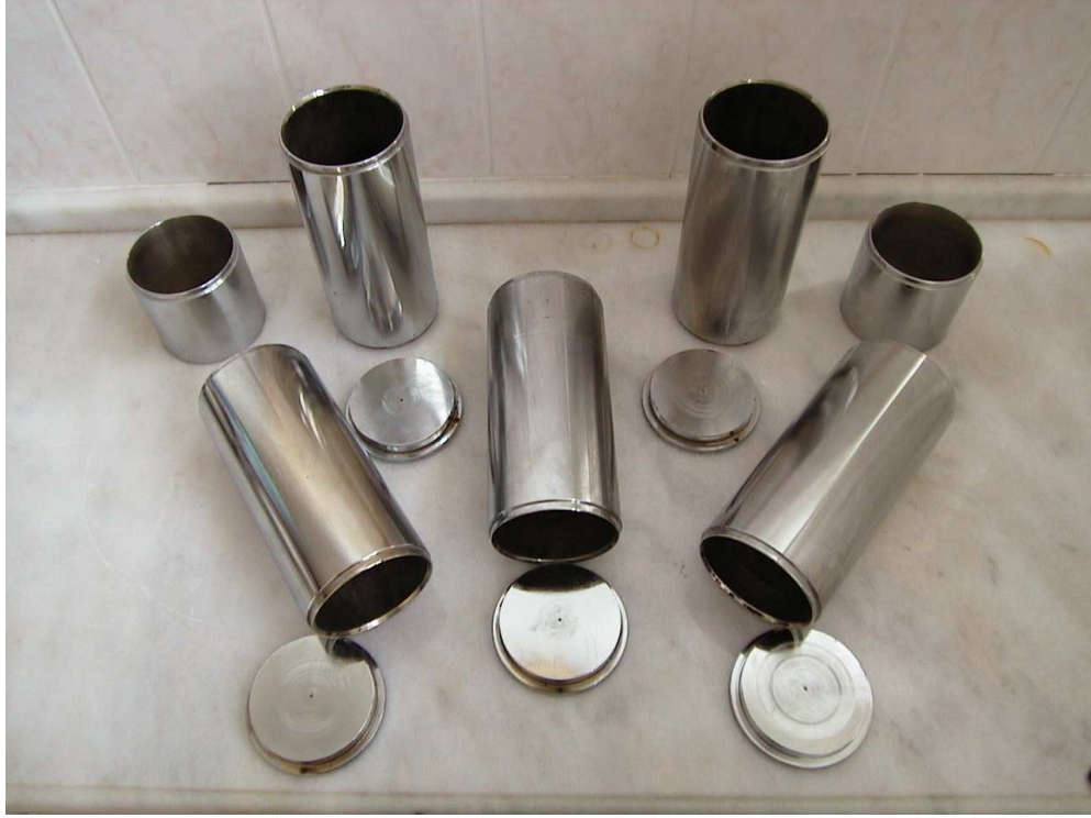
Şekil 5.5: Çift Taraflı Statik Sıkıştırma Yönteminde Kullanılan Numune Kalıpları
