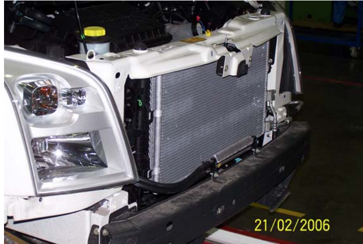
Şekil 4.6 : Batarya ve elektrik motoru için araca eklenen radyatör
