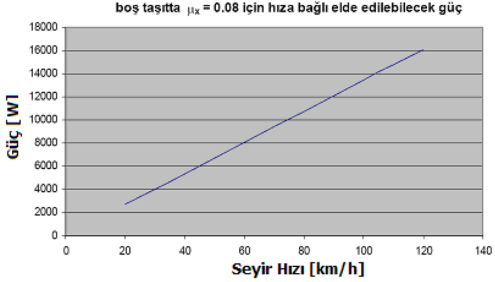
Şekil 4.23 : Doğrusal kuvvet bağlantı katsayısı \mu_x = 0.08 için arka akstan alınabilecek fren gücü [26]
