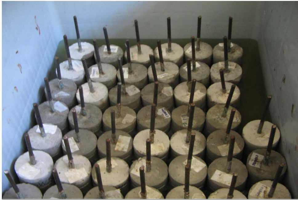
Şekil 7.24: Sodyum klorür çözeltisi içerisinde bekleyen lolipop numuneler
