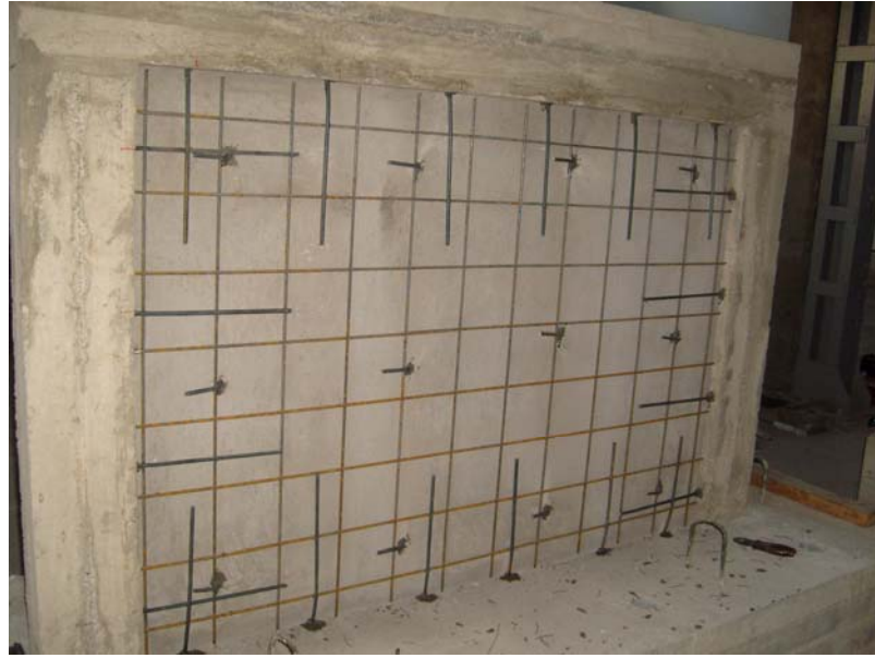
Şekil 3.30 : 3 no'lu numune ankraj detayları
