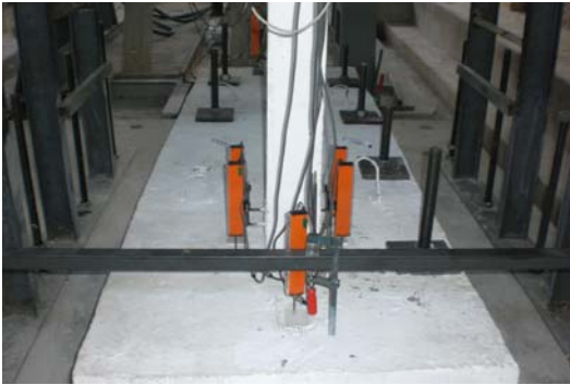
Şekil 3.39 : Boş çerçeve numunesine yatay yükleme yapılması
