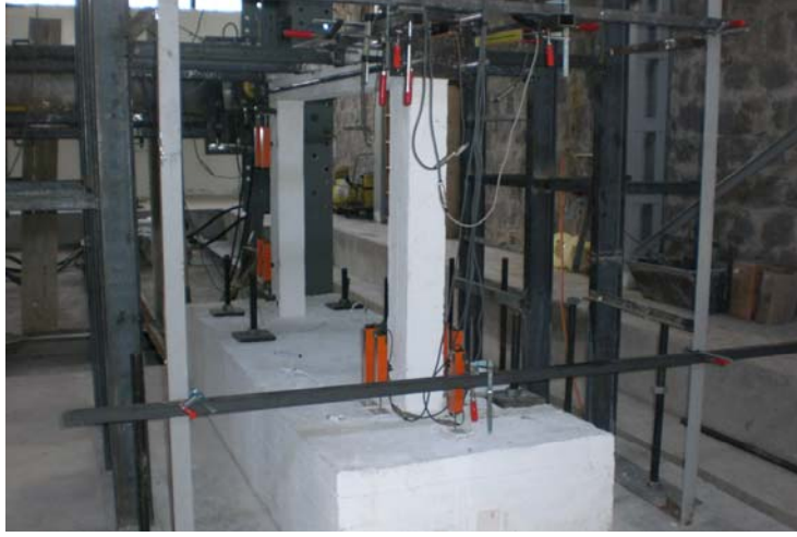
Şekil 3.39 : Boş çerçeve numunesine yatay yükleme yapılması
