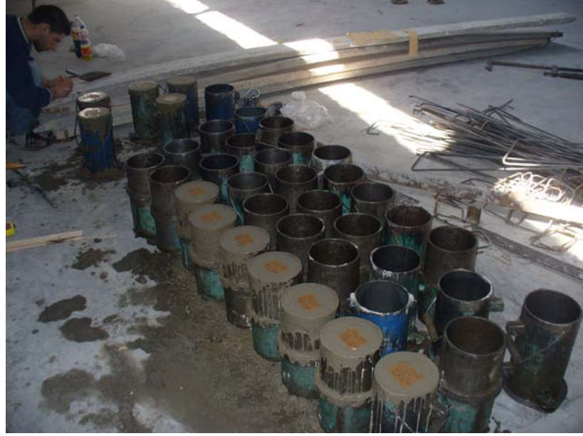
Şekil 3.9 : Beton numunelerinin alınması
