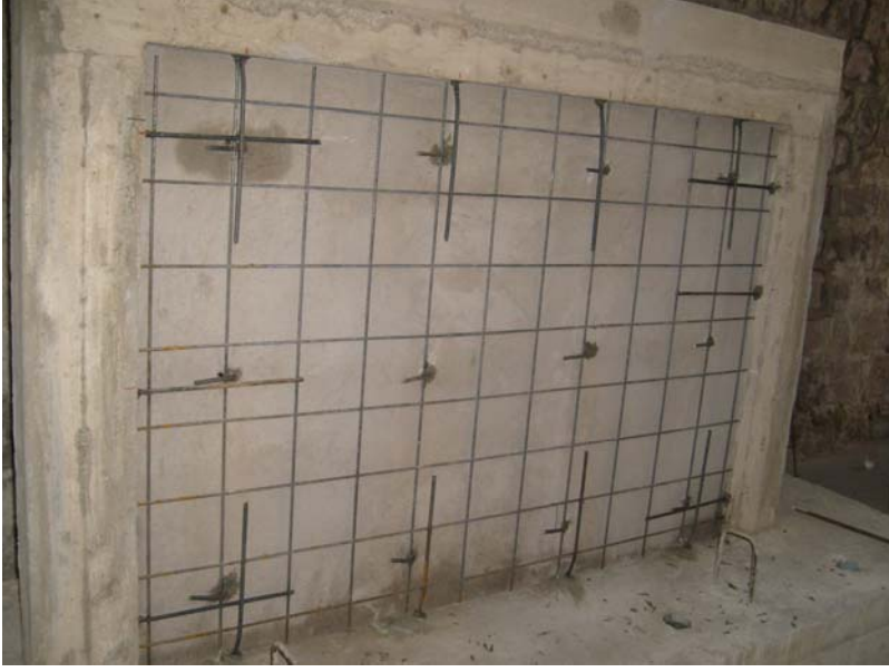
Şekil 3.31 : 4 no'lu numune ankraj detayları
