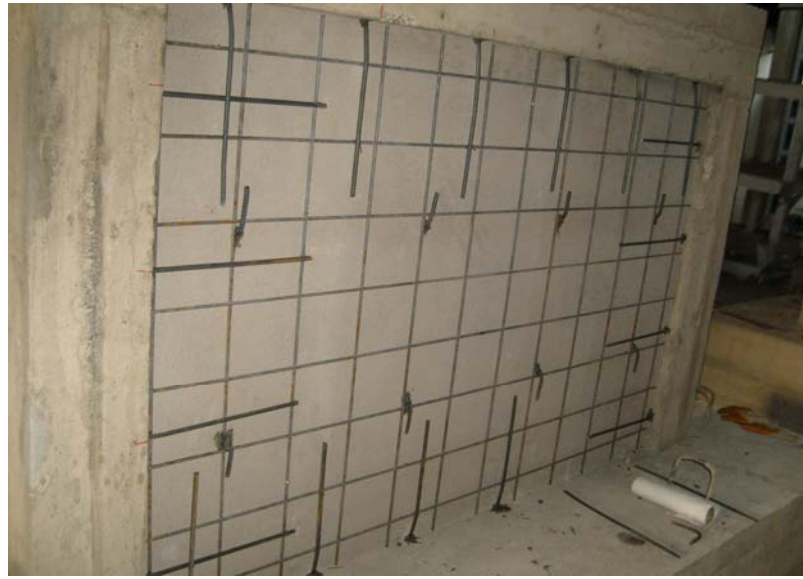
Şekil 3.33 : 6 no'lu numune ankraj detayları
