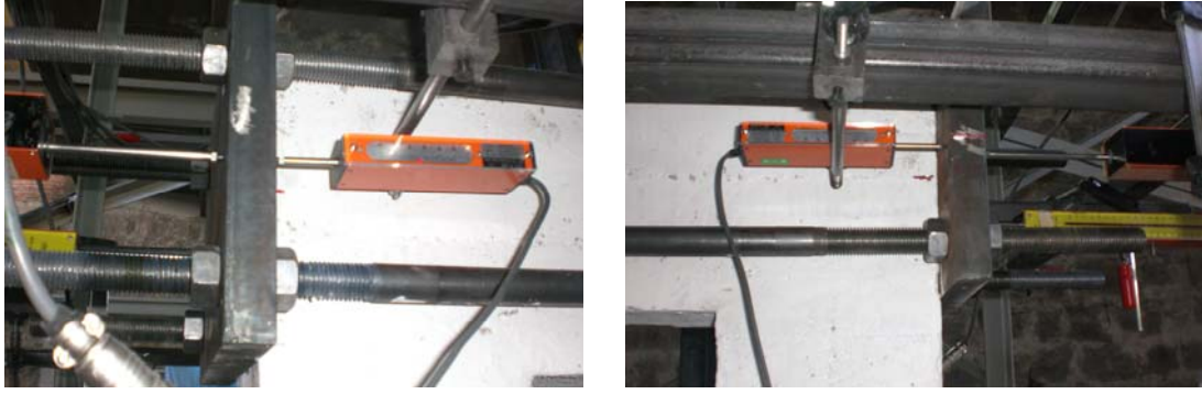
Şekil 3.40 : LVDT lerle numuneden veri toplanması
