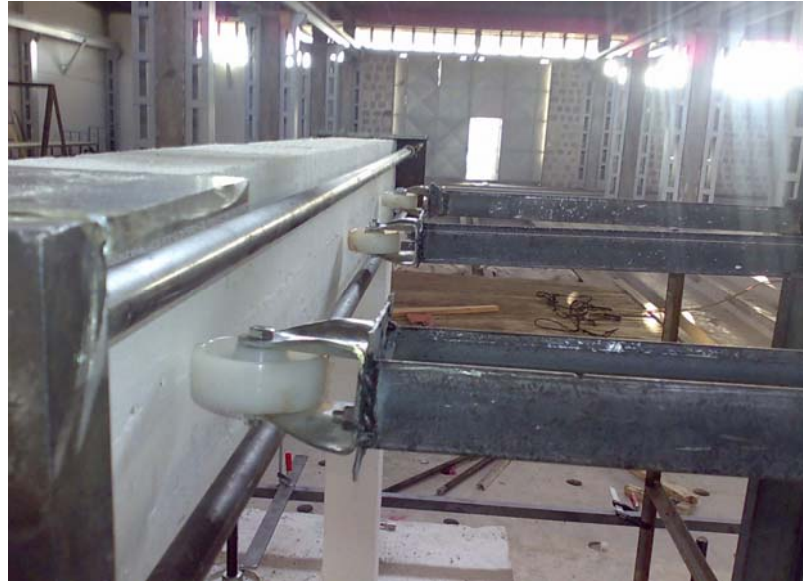
Şekil 3.34 : Düzlem dışı hareketi engellemek için yapılan kayıcı mesnetler
