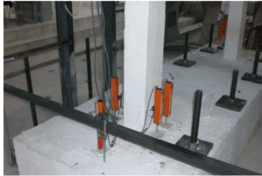
Şekil 3.39 : Boş çerçeve numunesine yatay yükleme yapılması
