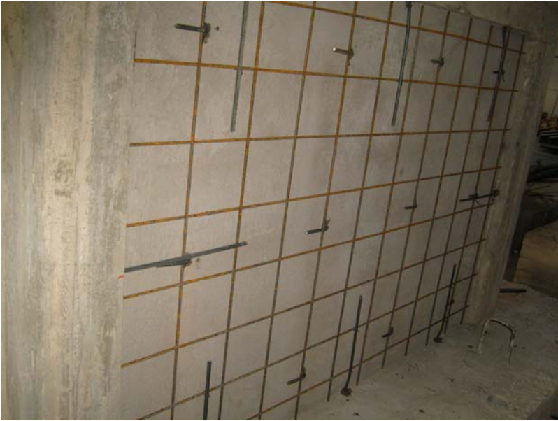
Şekil 3.32 : 5 no'lu numune ankraj detayları
