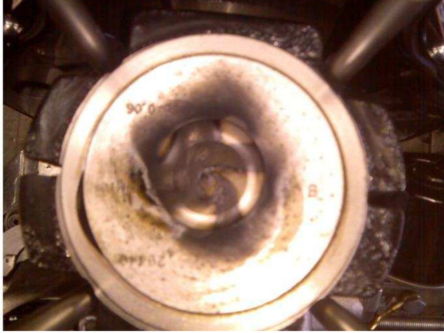
Şekil 6.8 Emme Portu Değiştirilmiş Silindir Kafası ile MR-1 50° lik Pistonun Beraber İlk Çalışması
