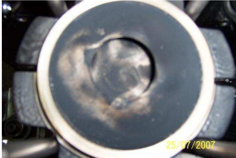
Şekil 6.9 Emme Portu Değiştirilmiş Silindir Kafası ile MR-1 50° lik Pistonun Beraber Çalışması 200 Saat Sonra
