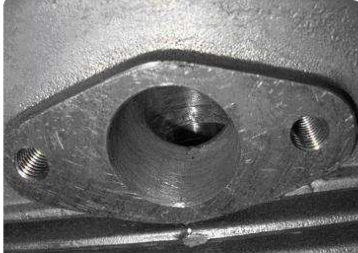
Şekil 3.11 Volumetrik Verimi Artıran Silindir Kafasının İmal Edilmiş Hali
