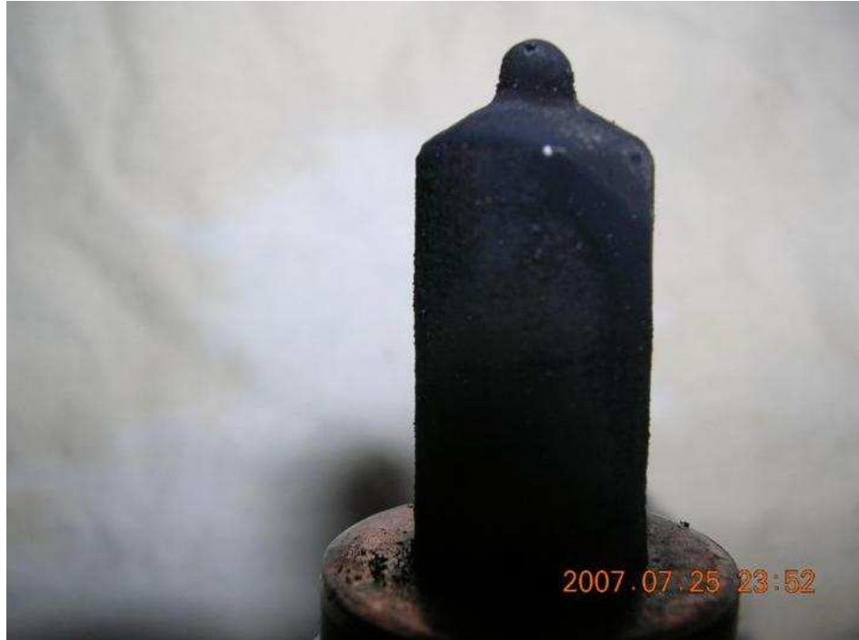
Şekil 6.13 Emme Portu Değiştirilmiş Silindir Kafasında Kullanılan Enjektörün 200 Saat Sonraki Hali
