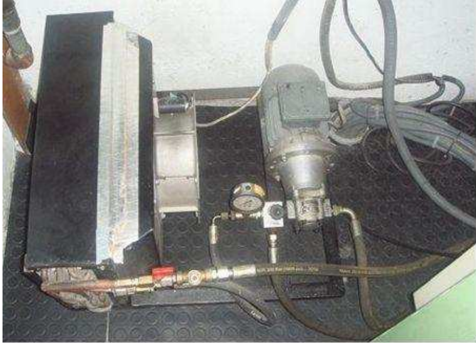
Şekil 5.6 Yağ Sıcaklığını Sabit Tutan Yağlı Radyatör
