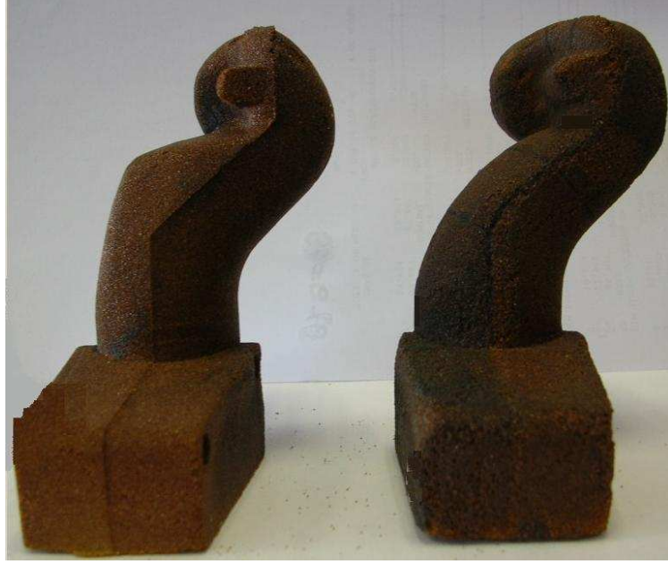
Şekil 3.10 Std. ve yeni emme portu maçaları (soldaki std.-sağdaki yeni)
