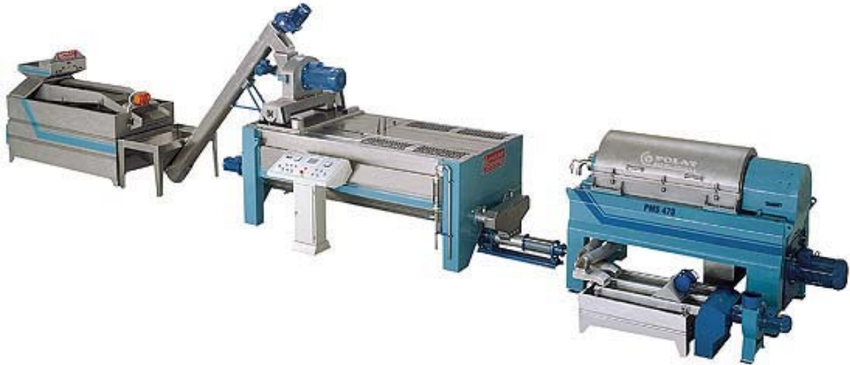
Şekil 2.2: Sürekli sistemlerden santrifüj sistemine örnek düzenek
