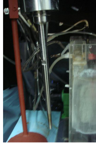
Şekil 3.44 : Ses dalgasını ileten prob.
