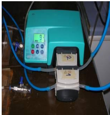
Şekil 3.26 : Ham su besleme ve vakum pompası.
